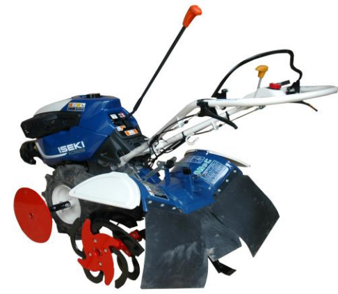
あぜ切器(コンクリートあぜ用)のセット写真
